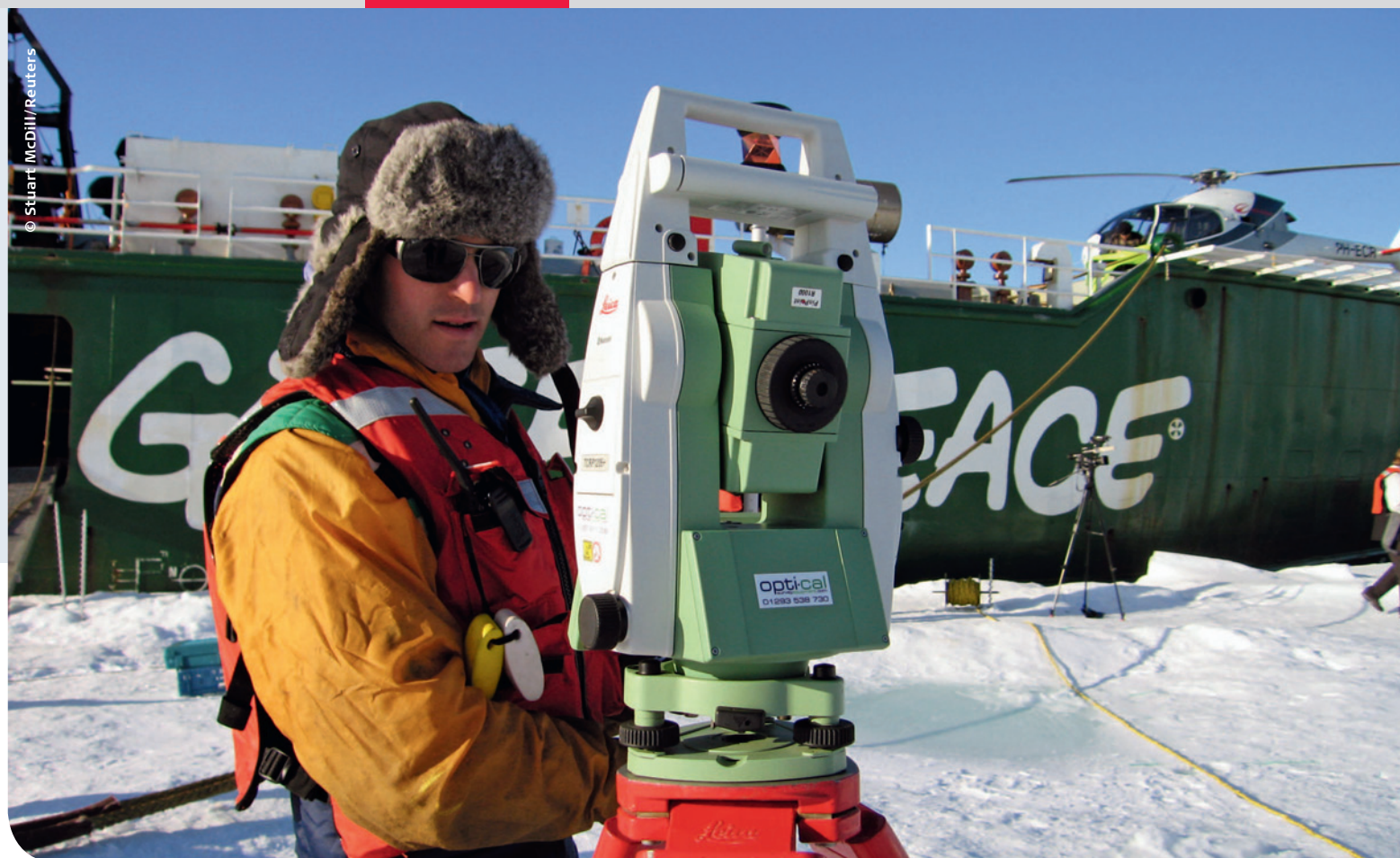
■ Nick Toberg installe une station totale TPS1200+ à proximité de l'Arctic Sunrise.
